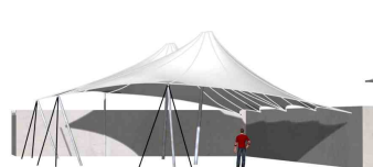
Toile haubanée avec fixations murales avec 2 mâts centraux
